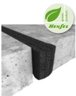
HENSOTHERM® 7 KS Fugenelement für den Verschluss von Bauteilfugen mit Brandschutzanforderung (EI30–EI90) und Fugenbreiten von 10–100 mm
