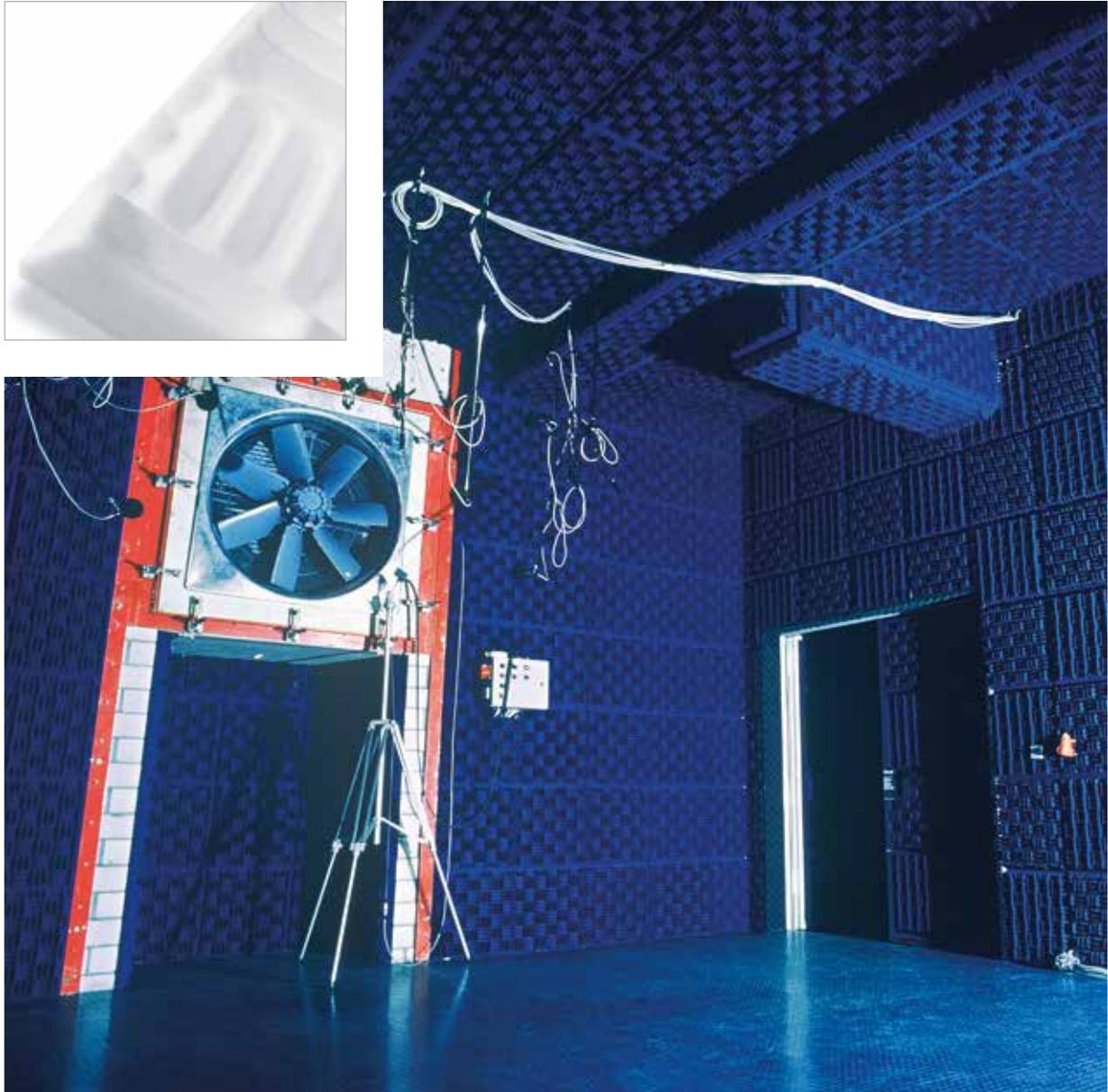
WAFFEL von pinta acoustic ist ein hervorragender Absorber für den mittleren und hohen Frequenzbereich. Zu den Vorteilen zählt neben der geringen Höhe und Leichtigkeit des Elements nicht zuletzt die attraktive Optik.
