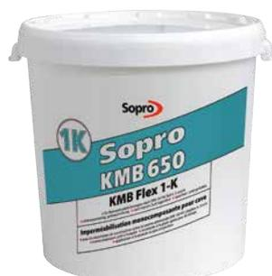
Einkomponentige, lösemittelfreie, polystyrolgefüllte, kunststoffmodifizierte Bitumen-Dickbeschichtung zur Herstellung von flexiblen, rissüberbrückenden Bauwerksabdichtungen nach DIN 18 195 Teil 4, 5 und 6 (aufstauendes Sickerwasser).
