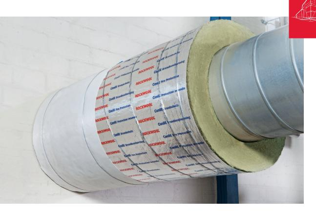
Die Conlit PS EIS 90 ist eine 80 mm starke nichtbrennbare Steinwollerohrschale. Sie ist mit einer farbig gekennzeichneten gitternetzverstärkten Aluminiumfolie kaschiert, einseitig aufgeschlitzt und zur leichteren Montage auf der Innenwandung eingesägt. Die Innendurchmesser der Rohrschalen sind auf gängige Wickelfalzrohre von DN 80 bis DN 300 abgestimmt.
