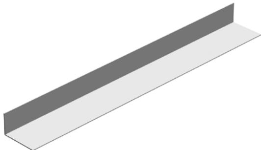
Rigips Abschlussprofile 14/25-05 dienen zur Herstellung von Abschlüssen in Gipsplattensystemen. Das Profil ist ungleichschenkelig und weist eine Schenkellänge von 14 mm und eine von 25 mm auf. Die Materialdicke beträgt 0,5 mm. Rigips Abschlussprofile 14/25-05 werden aus verzinktem Stahlband gefertigt.
