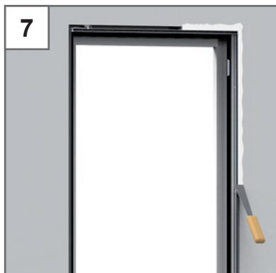
Fuge zwischen Rahmen und Wand mit nichtbrennbaren Baumaterialien umlaufend sorgfältig verspachteln. Dabei die obere Scharnierecke zunächst frei lassen um das Einhängen der Tür zu ermöglichen.
