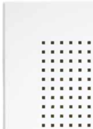
Micro, 3 x 3 mm, Achsabstand 8,3 mm Lochung: 10,2%
