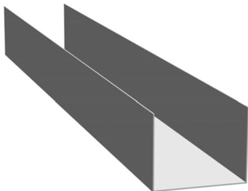
Rigips Wandprofile UW 75 für gleitende Deckenanschlüsse sind korrosionsgeschützte Metallprofile, die zur Erstellung von gleitenden Deckenanschlüssen in leichten Trennwänden dienen. Die Profile verfügen einen 60 mm breiten Flansch, der eine Bewegung des Anschlusses von 20 mm ermöglicht. Rigips U-Wandprofile für gleitende Deckenanschlüsse werden aus weichen unlegierten Stählen der Sorte DX51D+Z (Werkstoff Nr. 1.0226) mittels Kaltverformung gefertigt.
