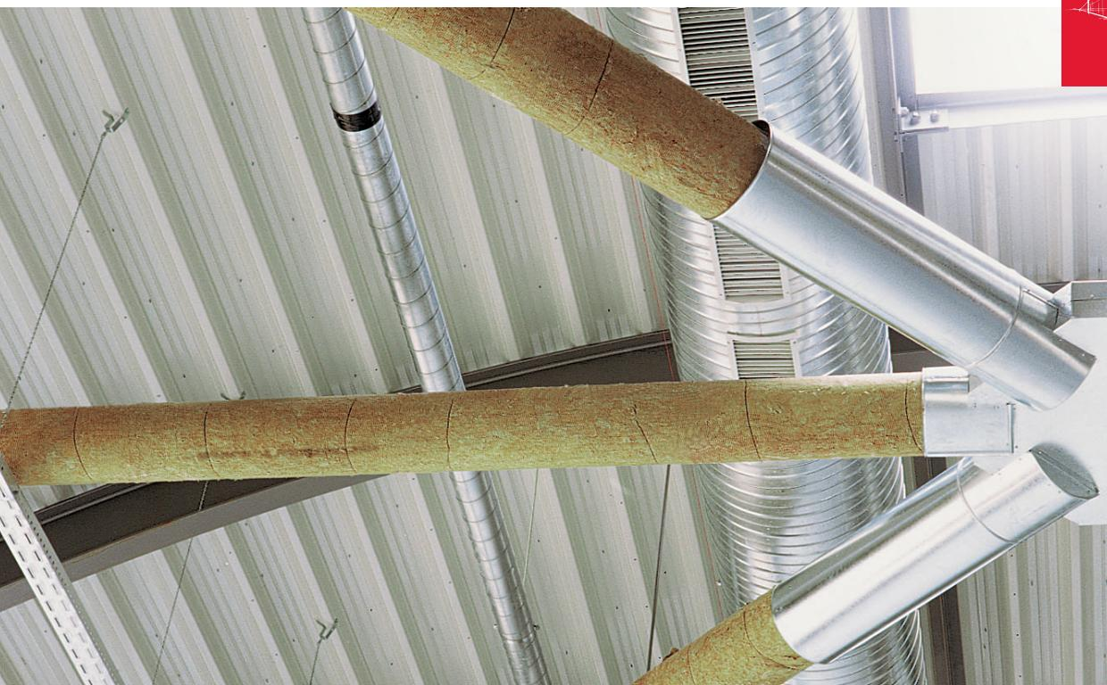
Die Conlit Steelprotect Section ist eine nichtbrennbare kunstharzgebundene druckfeste Steinwolle-Brandschutzschale, die vorzugsweise für Brandschutzanwendungen an runden Bauteilen verwendet wird. Sie wird als unkaschierte Variante (Conlit Steelprotect Section) und als mit gitternetzverstärkter Aluminiumfolie kaschierte Variante (Conlit Steelprotect Section Alu) angeboten. Die Conlit Steelprotect Section ist einseitig aufgeschlitzt und zur leichteren Montage auf der Innenwandung eingesägt.
