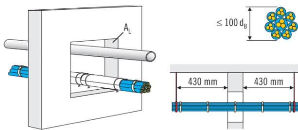
**Schritt 1:** Montage der Kabeltragsysteme / Kabelbündel und der Conlit Bandage (siehe oben). Kabelbündel, Kabeltragsysteme und Rohrleitungen müssen entsprechend der [ABZ-Nr. Z-19.15-1812](#) bzw. [1904](#) befestigt werden. Reinigung der Bauteillaubung  $A_L$ .
