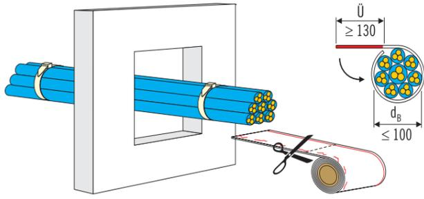
**Schritt 1:** Dichtgepackte Kabel mit Bindedraht fest zu einem Kabelbündel  $d_B \le 100$  mm schnüren. Bandage entsprechend dem Umfang des Kabelbündels +  $\ddot{U} \ge 130$  mm (Überlappung) ablängen. Bei Durchführung von metallischen Steuerleitungen ist die Conlit Bandage 2-lagig auszuführen.
