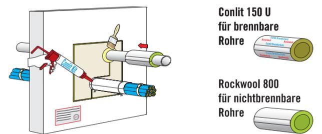
**Schritt 3:** Mögliche Restquerschnitte mit Conlit Kit oder Conlit Fix verschließen. Stöße mit Conlit Kit  $\ge 10$  mm Breite und 1 mm Dicke abdecken. Verkleben der Rockwool Rohrschalen mit dem Conlit Penetration Board mit Conlit Kit oder Conlit Fix. Rohrschalen mit einem Bindedraht ( $d \ge 0,6$  mm) mit 8 Wicklungen/lfd. M. sichern. Übereinstimmungserklärung und Typenschild ausfüllen. Typenschild neben der Abschottung montieren.
