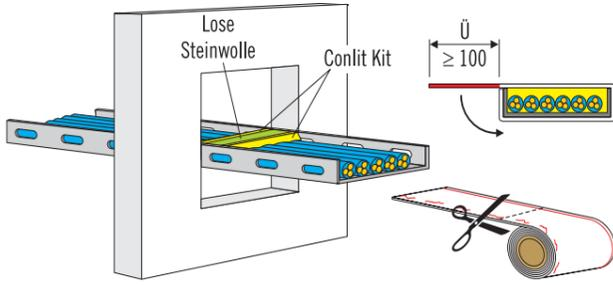
**Schritt 1:** Dichtgepackte Kabel mit Bindedraht fest auf dem Tragsystem fixieren. Den Durchführungsbereich mit loser Steinwolle ausstopfen und mit Conlit Kit abdichten. Bei Lagenanordnung max. Durchmesser des Einzelkabels 22 mm. Bandage entsprechend dem profilfolgenden Umfang + Überlappung von 100 mm ablängen.
