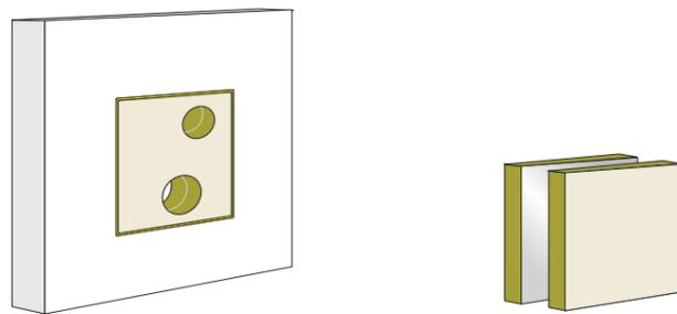
**Schritt 1:** Reinigung der Bauteillaubung  $A_L$ . Einkleben des Conlit Penetration Board mit Conlit Kit oder Conlit Fix (Kleber) in die Bauteilöffnung und setzen der „Kernbohrungen“.
