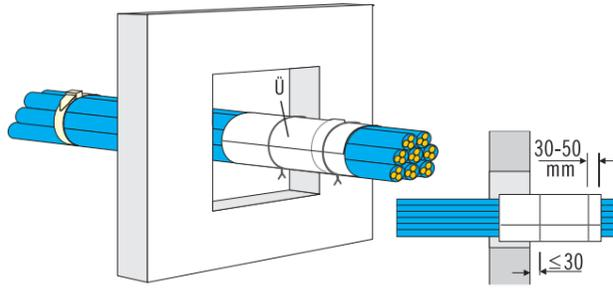
**Schritt 2:** Conlit Bandage (Breite 380 mm) mit der Schriftseite nach außen fest um das Kabelbündel legen. Mit Bindedraht ( $d \ge 0,6$  mm) nach aussen mit 30 - 50 mm und nach innen mit  $\le 30$  mm Abstand zur Überlappung fixieren. Die Überlappung  $\ddot{U} \ge 130$  mm ist zu beachten.
