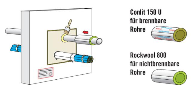
**Schritt 3:** Verkleben der Rockwool Rohrschalen mit dem Conlit Penetration Board. Rohrschalen mit einem Bindedraht ( $d \ge 0,6$  mm) mit 8 Wicklungen/lfd. M. sichern. Übereinstimmungserklärung und Typenschild ausfüllen. Typenschild neben der Abschottung montieren.
