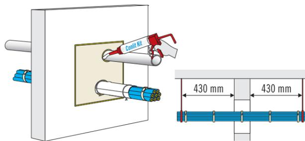
**Schritt 2:** Leitungen durchführen, Montage der Kabelbündel und der Conlit Bandage, siehe oben. Restquerschnitt mit Conlit Kit verschließen. Kabelbündel und Rohrleitungen müssen entsprechend der [ABZ-Nr. Z-19.15-1812](#) befestigt werden.
