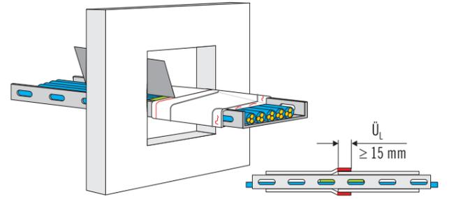
**Schritt 3:** Die zweite Conlit Kabelbandage unter Berücksichtigung der Überlappung  $\ddot{U}_L \ge 15$  mm (rote Strichmarkierung) wie Schritt 2 montieren.
