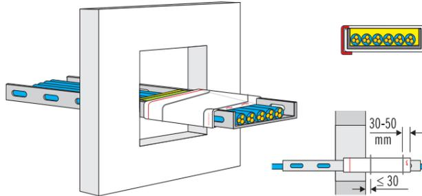
**Schritt 2:** Conlit Bandage (Breite 380 mm) mit der Schriftseite nach außen, profilfolgend um das Tragsystem + Kabel legen. Die Bandage mit Bindedraht fixieren.
