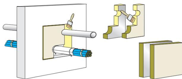
**Schritt 2:** Einmessen der Bauteilöffnung und Leitungen. Übertragen der Maße auf das Conlit Penetration Board. Stramm-sitzender Einbau der Conlit Penetration Boards mit der Alukaschierung nach innen. Verkleben des Conlit Penetration Board mit dem Bauteil und der Zuschnitte untereinander mit Conlit Kit oder Conlit Fix (Kleber).
