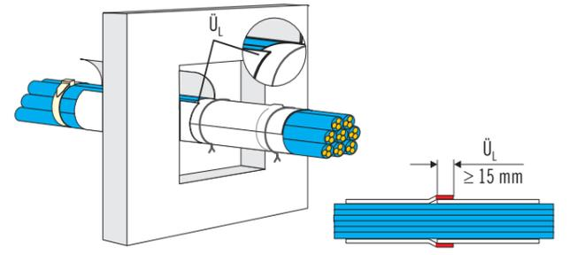
**Schritt 3:** Die zweite Conlit Kabelbandage unter Berücksichtigung der Überlappung  $\ddot{U}_L \ge 15$  mm (rote Strichmarkierung) wie Schritt 2 montieren. Bei Montage in Kernbohrungen empfehlen wir, die Bandagen vor der Öffnung zu montieren und dann in die Kernbohrung zu schieben.
