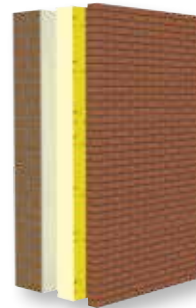
Kerndämmung im zweischaligen Mauerwerk
