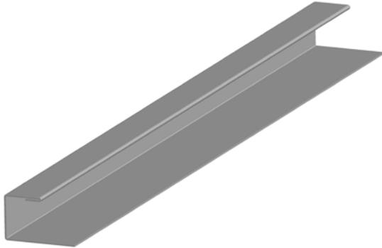
Rigips Einfassprofile 12,5 Stahl weiß dienen zur Herstellung von Abschlüssen und Einfassungen in Gipsplattensystemen. Das Profil ist auf eine Plattenstärke von 12,5 abgestimmt und weist ein Innenmaß von 12,6 mm auf. Die Materialdicke beträgt 0,5 mm. Rigips Einfassprofile 12,5 Stahl weiß werden aus lackiertem Stahlband gefertigt.
