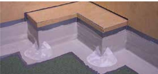
Bei Innen- und Aussenecken muss mit zusätzlichen Vlieseinlagen gearbeitet und an den entsprechenden Stellen nochmals genügend Material vorgelegt werden. Dieser Schritt kann ebenfalls Nass in Nass erfolgen, es entstehen keine Wartezeiten zwischen den einzelnen Schichtaufträgen.
